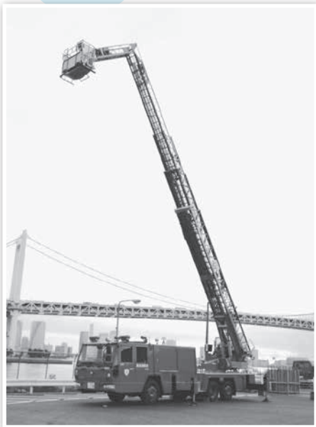
品川消防署には東京消防庁で1台しかない先端屈折型のはしご車が配置になっています ※品川消防署HPより
