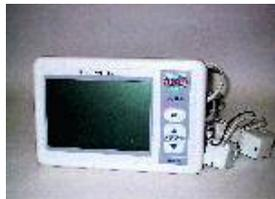
家庭の分電盤のメインブレーカーにクランプをはさみ、電気料金情報を入力すればセッティング完了。「これくらいまでは節約したい」という設定ができ、達成度を数値やグラフィックで表示するので、地球にも、家計にもやさしい生活を気軽なゲーム感覚でアシストしてくれます。
